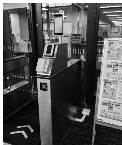
図4 サーモカメラを取り付けた入館ゲート
