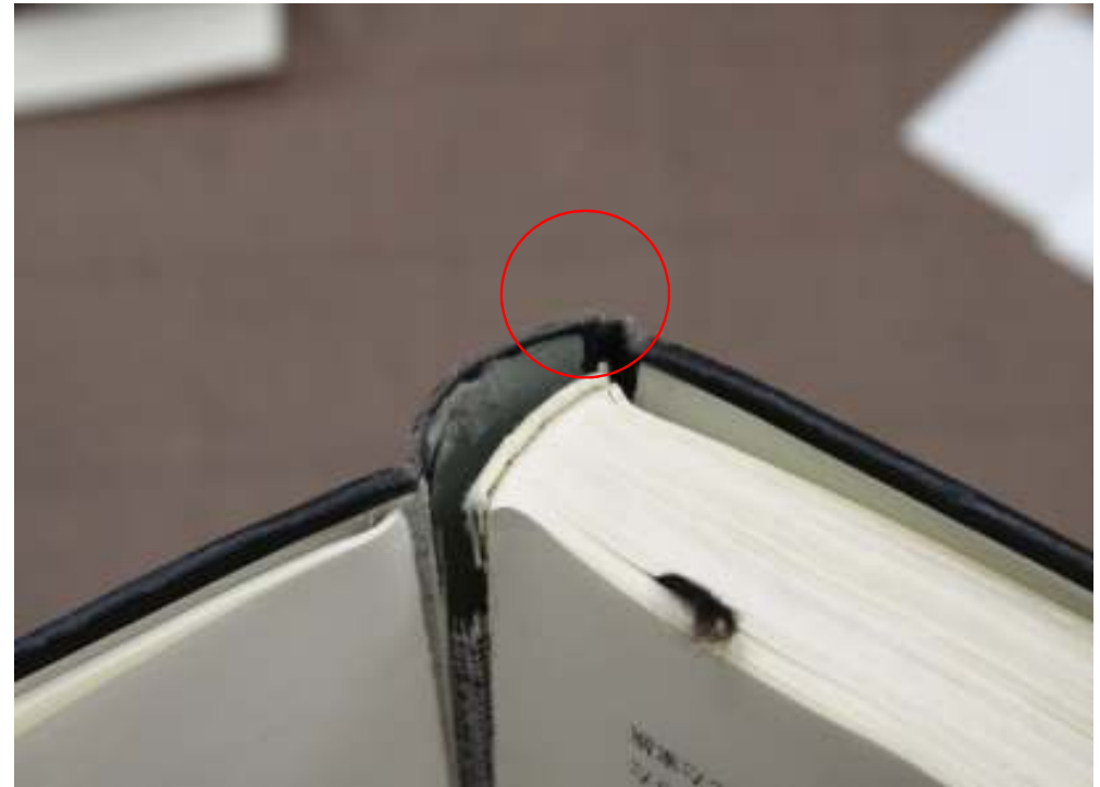
背幅より狭いクータを入れたため、短期間で再破損
