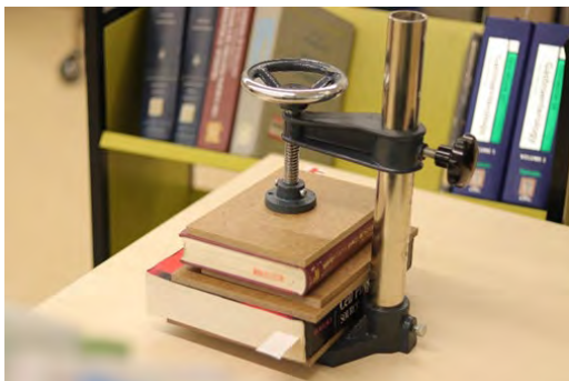
②落下した図書の修理用プレス機購入(軽微な破損は日常業務の中で修理)
